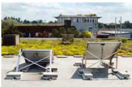
Beim Versuchsaufbau auf einem ZinCo Dach wurden die Temperatur-Differenzen verschiedener Dachaufbauten über das gesamte Jahr 2009 hinweg gemessen.
