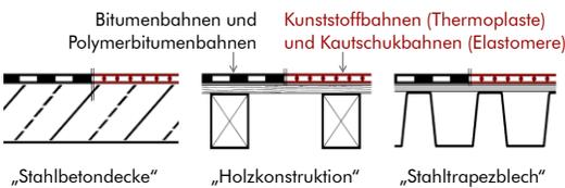
Die Dachabdichtung muss entsprechend der einschlägigen Normen und Richtlinien ausgeführt werden!
