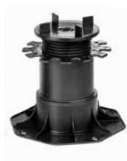
Elefeet® H 145 Verstellbereich von 145–225 mm
