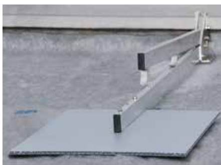
Das Pfostenmodul wird fertig vormontiert geliefert, lediglich der Pfosten selbst muß noch senkrecht oder in einem Winkel von 67,5 Grad montiert werden.
