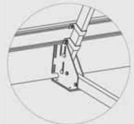
Pro Pfosten vier Hammerkopfschrauben in die T-Nut des Bordbretts einsetzen und in die Bohrungen der Haltebleche am Pfosten einführen. Anschließend Muttern anbringen und festziehen.
