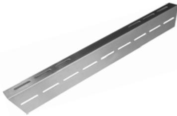
Aus einem Stück gefertigtes Adapterprofil, welches die Aufnahme besonders großer Module auf dem ZinCo Solar-Grundrahmen SGR ermöglicht. Pro SGR können bis zu zwei Adapterprofile angebracht werden (je eines oben und unten). Befestigung mit mind. 2 Schrauben je Profil. Die Auflagefläche der Adapterprofile auf dem Grundrahmen muss mindestens 25 cm betragen, somit krägt das Adapterprofil max. 45 cm über diesen hinaus.
