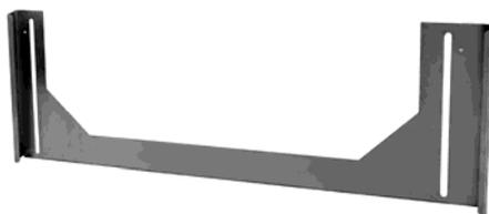
Spezielles Rahmen-Unterteil, welches auf der Solarbasis SB 200 verschraubt und in das ein Solar-Grundrahmen SGR von oben eingeführt und ebenfalls verschraubt wird. Schlitz ermöglichen eine stufenlose Höhenverstellung des eingesetzten SGR von bis zu 21 cm und eine Verstellung des Neigungswinkels um bis zu  $\pm 2^\circ$ . So lassen sich PV-Module optimal an wechselndes Dachgefälle anpassen und ausrichten.
