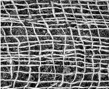
Grobmaschiges Gewebe aus 100 % Jute zum Einsatz als Erosionsschutz auf frisch humusierten Flächen, z. B. im Schrägdach-, Ufer- und Böschungsbereich.
