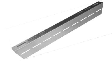
Aus einem Stück gefertigtes Adapterprofil, welches die Aufnahme besonders großer Module auf dem ZinCo Solar-Grundrahmen SGR ermöglicht. Pro SGR können bis zu zwei Adapterprofile angebracht werden (je eines oben und unten). Befestigung mit mind. 2 Schrauben je Profil. Die Auflagefläche der Adapterprofile auf dem Grundrahmen muss mindestens 25 cm betragen, somit kräftet das Adapterprofil max. 45 cm über diesen hinaus.
