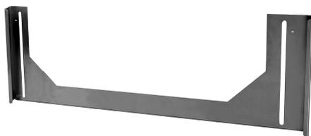
Spezielles Rahmen-Unterteil, welches auf der Solarbasis SB 200 verschraubt und in das ein Solar-Grundrahmen SGR von oben eingeführt und ebenfalls verschraubt wird. Schlitze ermöglichen eine stufenlose Höhenverstellung des eingesetzten SGR von bis zu 21 cm und eine Verstellung des Neigungswinkels um bis zu  $\pm 2^\circ$ . So lassen sich PV-Module optimal an wechselndes Dachgefälle anpassen und ausrichten.
