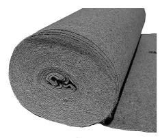
Preiswerte Synthesefasermatte zum Einsatz als Trenn- und Schutzlage unter Kiesschüttungen und extensiven Dachbegrünungen.
