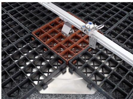
Durch Auflast gehaltene Anschlageinrichtung gemäß DIN EN 795 Typen D + E mit horizontal beweglichem Anschlagpunkt für kurzzeitige Arbeiten mit einer Persönlichen Schutzausrüstung (z. B. ZinCo Fallnet® PSA-Set, Art.-Nr. 9024) auf Flachdächern bis max. 5° Dachneigung.
