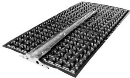
Durch Auflast gehaltene Konstruktionsbasis für durchdringungsfreie Geländerlösungen (auf Anfrage auch mit zusätzlicher Befestigungsmöglichkeit für Fallnet® SB 200-Rail) auf Flachdächern oder Dachterrassen. Die Auflast kann durch Plattenbeläge im Splittbett oder Schüttgüter (Kies, Begrünungssubstrate, etc.) erbracht werden.
