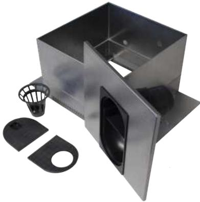
Kontrollschacht zum Anschluss eines Fallrohrs (DN 80—125) mit Rückstauklappe und Revisionsöffnung
