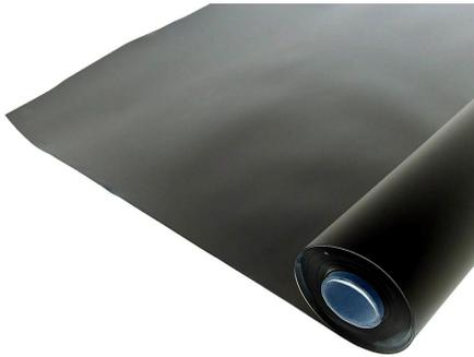
Mittels Heißluft zu verschweißende, bitumenbeständige Bahn aus Recycling-PVC, einsetzbar als zusätzlicher Wurzelschutz unter extensiven und intensiven Begrünungen auf nicht wurzelfest abgedichteten Dächern.
