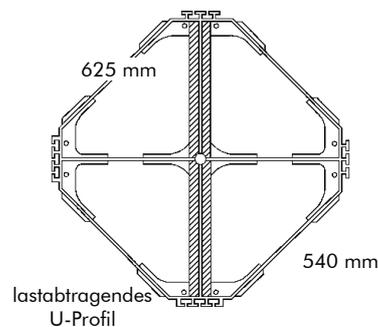
Der Verbund der Elemente erfolgt über integrierte T-Profile
